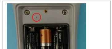
Figure 14: Emplacement du trou d'accès pour l'alignement
